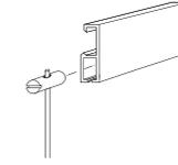
Cimaise alu blanc brillant avec câble acier (diamètre 1,5 mm), glissière et crochet à bec (poids maxi 7 kg)
